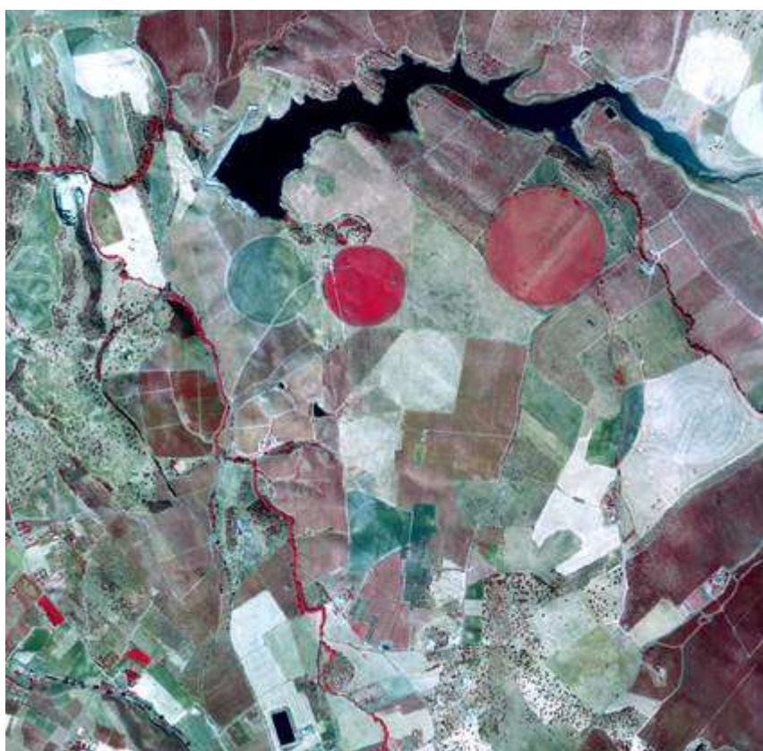
Extrato de um ortofotomapa na composição Infravermelho Próximo, Vermelho e Verde.
