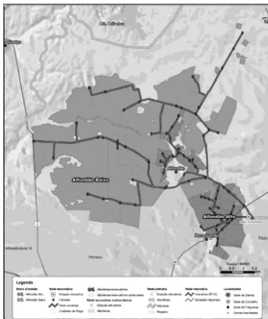
O bloco de Alfundão Alto, tem uma área de 630 ha, englobando toda a zona de pequena propriedade, junto às povoações de Peroguarda e Alfundão. Este bloco é pressurizado a partir da estação elevatória de Alfundão, que por sua vez é abastecida através de um reservatório semiescavado, localizado na extremidade do adutor do Alfundão.
